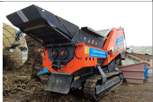
Der EKOMAXX 800 von ARJES ist zudem mit einem großvolumigen und hydraulische verstellbaren Kipprichter ausgestattet
