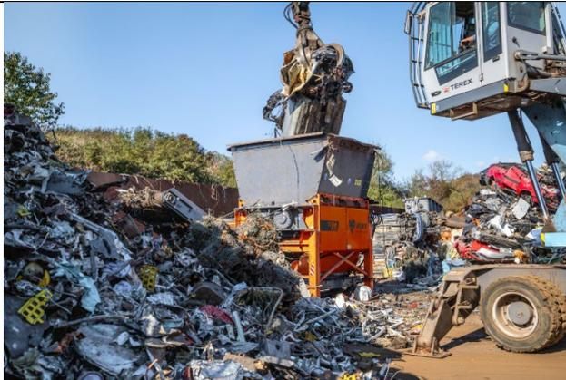
Der leistungsstärkste ARJES Zerkleinerer TITAN 950 e-pu wird besonders für die Vorzerkleinerung von Leichtschrottanwendungen und Autokarosserien empfohlen
