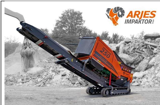
Der dieselmobiler Zweiwellenzerkleinerer IMPAKTOR 250 evo II wird künftig über die neu gegründete ARJES IMPAKTOR GmbH gefertigt und vertrieben
