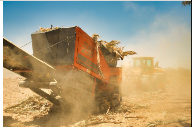
Extreme Belastungen durch Temperaturen über 45 °C sowie Feinstaub und Sand machen der Maschine schwer zu schaffen
