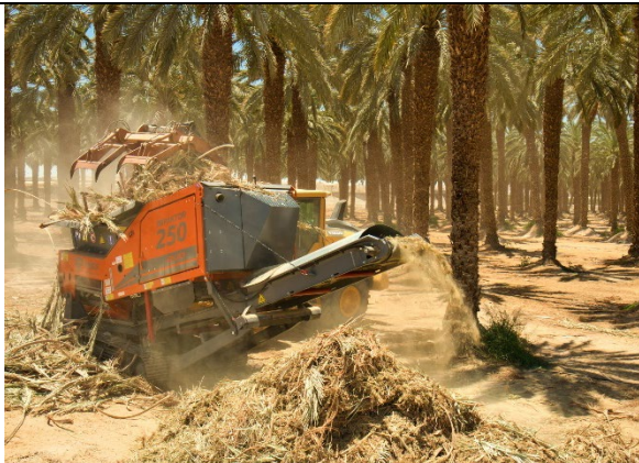
Voller Einsatz für den ARJES IMPAKTOR 250 evo bei der Zerkleinerung von Palmwedeln
