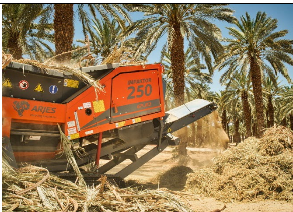
Durch das asynchrone Zweiwellen-Prinzip und den bissigen Paddelwellen meistert der IMPAKTOR 250 evo auch diese Herausforderungen
