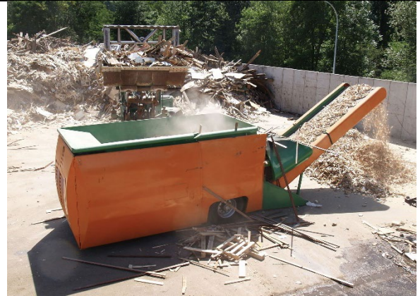
Entwicklung des ersten Prototypen VZ 750 zur Aufbereitung von Grünschnitt und Altholz im Jahr 2007
