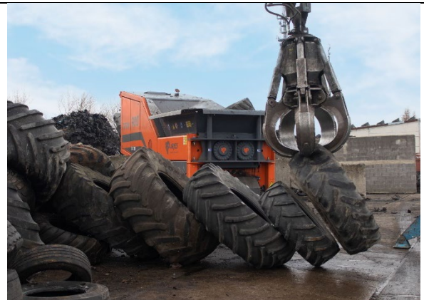
Selbst tonnenschwere EM-Reifen mit einem hohen Anteil an Stahlgewebe werden mit dem TITAN 900 zerfetzt
