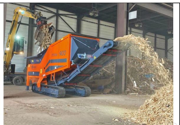
Sin conversión, la ARJES TITAN 900 procesa hasta 200 t/h de residuos de madera
